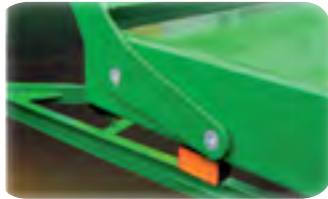
Zastosowanie śrub z wpuszczonymi łbami i dwupunktowy system mocowania drabinek oporowych
