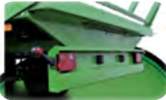
Tylne zabezpieczenie najazdowe zintegrowane z tylnym oświetleniem
