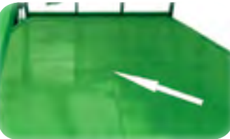
Zastosowanie jednej tylko spoiny centralnej na platformie poprawia właściwości estetyczne, użytkowe oraz trwałość przyczepy
